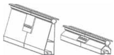
❷ Querträgerprofile FixZ-7 montieren. Profilstoß mit Verbinderplatte und selbstbohrenden Schrauben befestigen.
